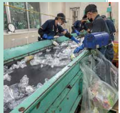
ペットボトルの手選別コンベヤの異物除去作業
